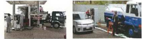
移動タンク貯蔵所と可搬式給油設備を接続した例
